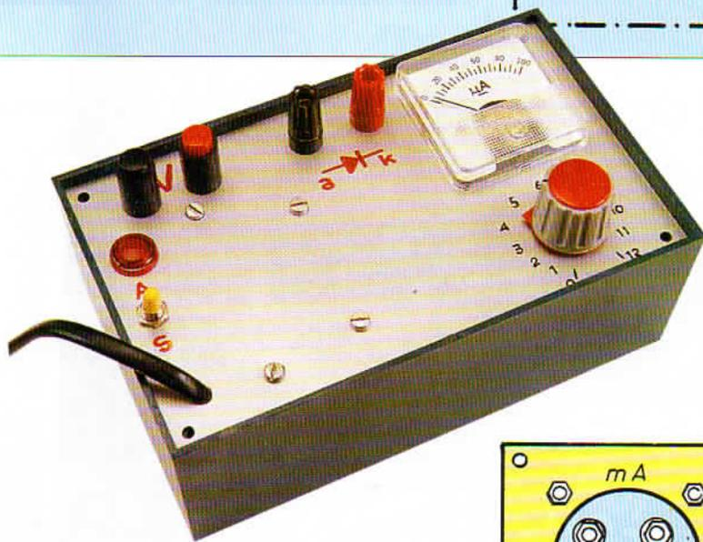
**Ecco il circuito montato nel suo aspetto definitivo e pronto per funzionare. La scatola utilizzata per il nostro prototipo è una Teko P3.**
